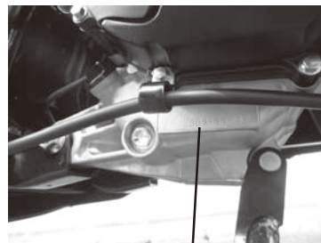
引擎號碼刻印於左側曲軸箱上
